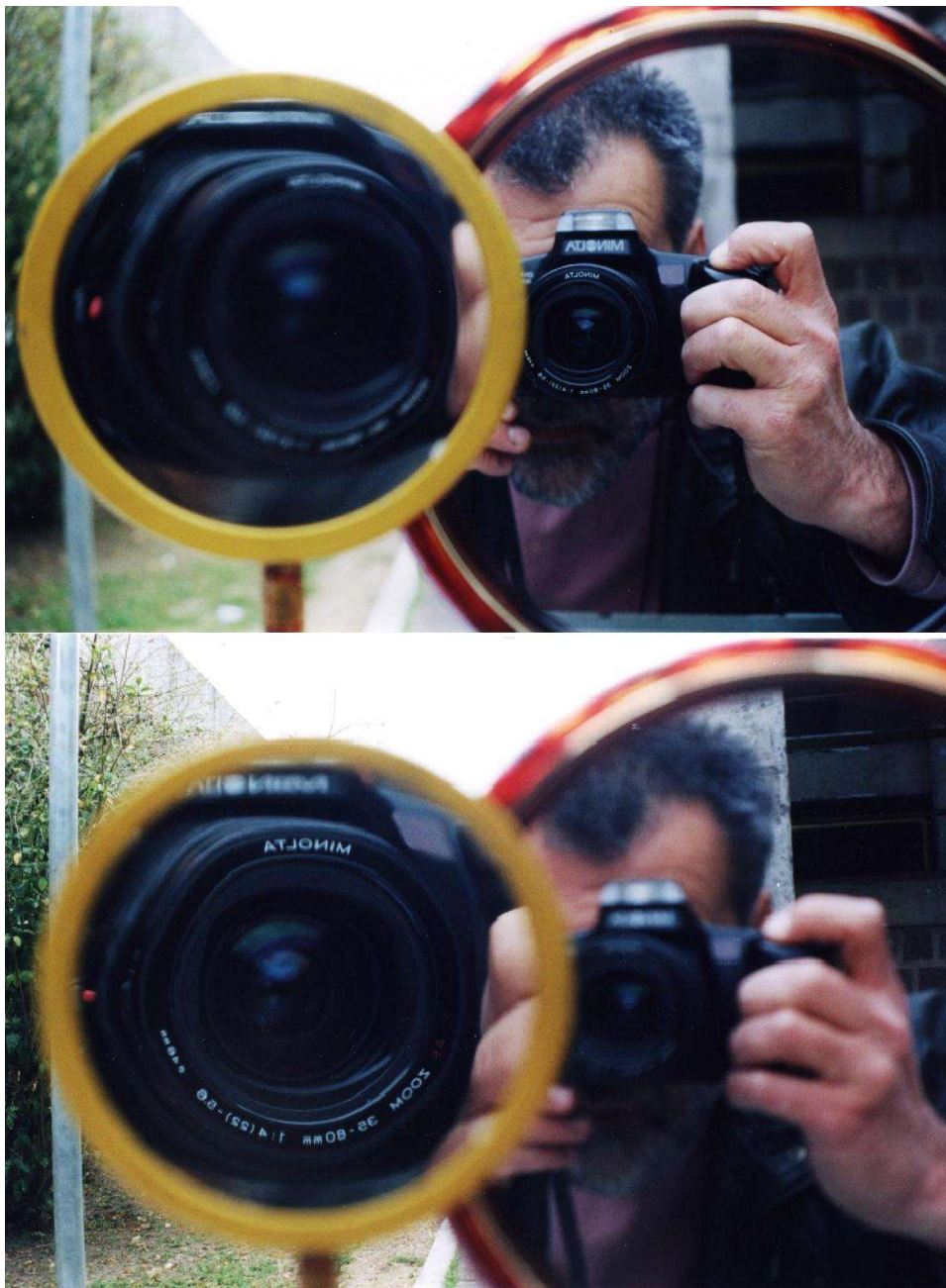
Figura 15 - Comparação do que se vê em um espelho plano com o que se vê em um espelho côncavo, posicionando a objetiva da máquina fotográfica no plano focal do espelho côncavo.
