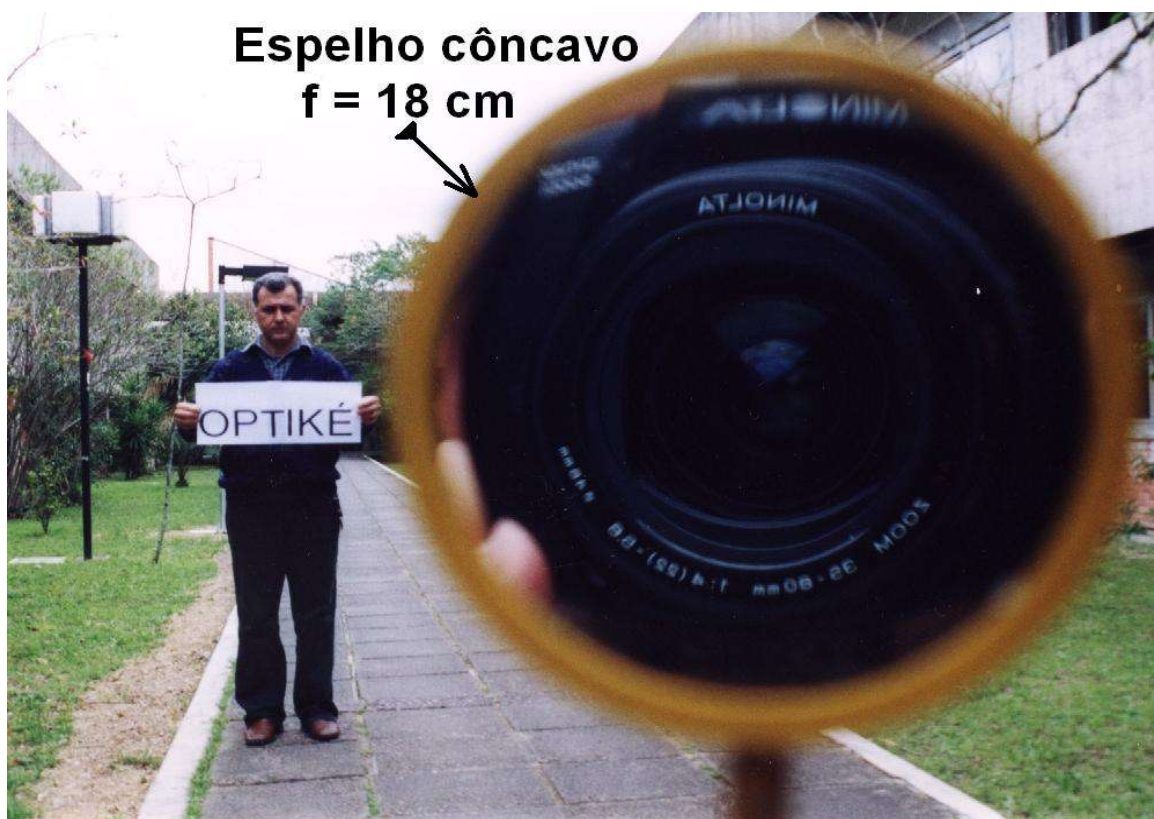
Figura 13 - Fotografia mostrando a objetiva da máquina fotográfica localizada no plano focal do espelho côncavo. O espelho está contido na moldura que na foto aparece pouco nítida.
