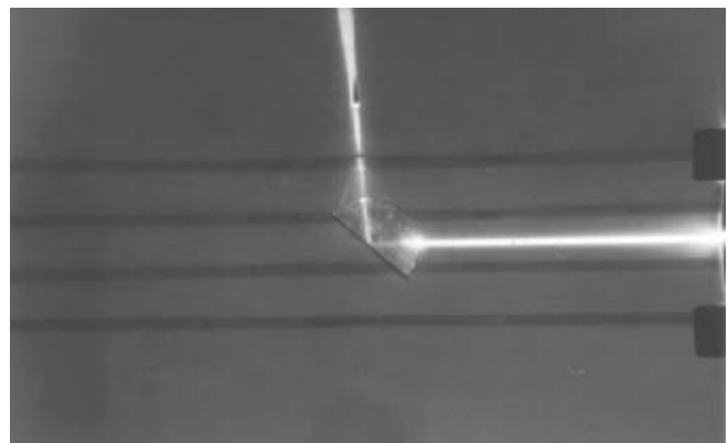
Figura 4. Semicírculo com incidência de um feixe num ângulo maior que o ângulo crítico, que resulta no processo de reflexão total interna.
