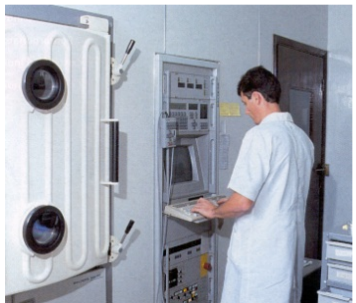
Evaporadora Balzers-Leybold BAK-760
