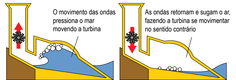
Figura 5.4 – Geração de energia em usina maremotriz.
