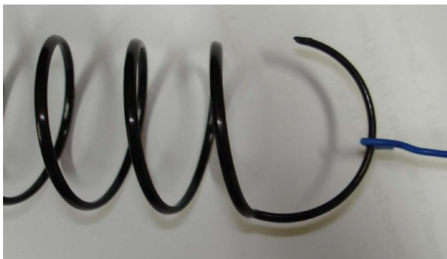
Figura 6 – Detalhe sobre a alça dobrada na extremidade da espiral.
