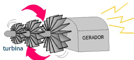
Se as pás forem movidas por passagem de vapor, obtido por aquecimento de água, como se fosse uma grande chaleira, tem-se, então, uma **Usina Termelétrica**. O calor pode ser gerado pela queima de óleo combustível, carvão ou gás.
