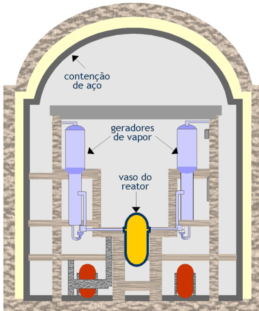
***O Edifício do Reator, construído em concreto e envolvendo a Contenção de aço, é a quarta barreira física que serve para impedir a saída de material radioativo para o meio ambiente e, além disso, protege contra impactos externos (queda de aviões e explosões).***
