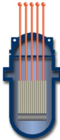
Esse enorme recipiente, denominado **Vaso de Pressão do Reator**, é montado sobre uma estrutura de concreto, com cerca de 5 m de espessura na base.
