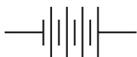
Figura 8. O símbolo de uma bateria se assemelha a uma associação em série de geradores.
